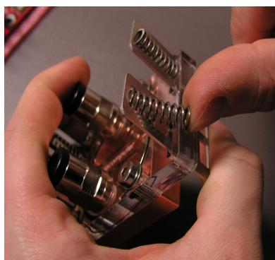
Anpressfedern wie auf der Abbildung zu sehen oberhalb des Deckels in die Bleche ein. Nun kann der Kühler auf den wie oben beschrieben mit Wärmeleitpaste vorbereiteten Prozessorkern aufgesetzt werden. Achten
