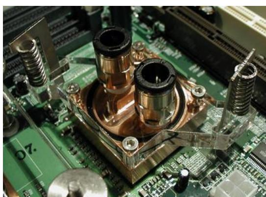
gesetzt. Der twinplex wird nun vorsichtig so auf den Chipsatz aufgelegt, dass die Nasen des Plexiglasdeckels sich oben auf die Federn legen. Der Kühler wird nun vorsichtig auf den twinplex gesetzt, bis die Nasen des Plexiglasdeckels die Federn berühren. Anschließend kann der Kühler mit einer Schraube am Gehäuse befestigt werden.
