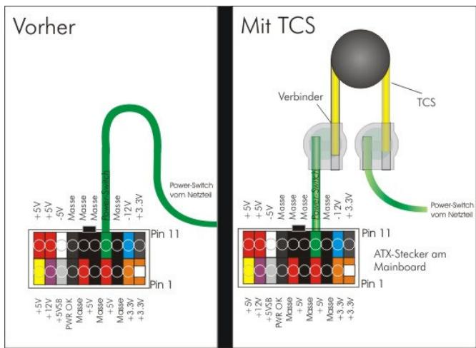
Kabel bis zum Anschlag in die Kunststoffverbinder ein und drücken Sie den Verbinder zusammen. Im Betrieb kann das TCS nun bei zu hohen Temperaturen der CPU bzw. des CPU-Kühlers die Stromversorgung unterbrechen und somit recht wirksam eine Zerstörung der Hardware verhindern. Bitte beachten Sie, dass in diesem
