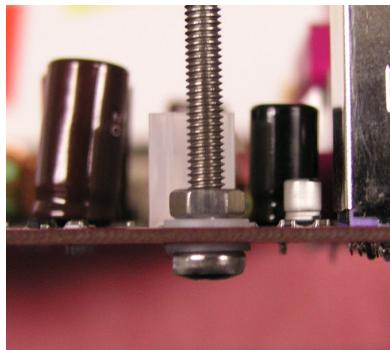
Schrauben befestigen. Hierzu müssen Sie zuerst Ihr Motherboard vom Gehäuse demontieren. In P4- und Xeon-Systemen muss zunächst die meist schwarze Kunststoffbefestigung für Luftkühler vom Motherboard entfernt werden, um die benötigten Bohrungen im Motherboard freizulegen. Anschließend streifen Sie über eine der beiliegenden Edelstahlschrauben in M4
