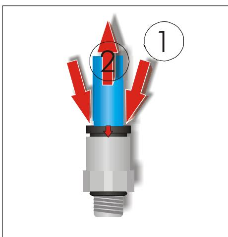
1. Schwarzen oder blauen Kunststoffring am Verbinder nach unten drücken. Dazu kann auch das separat angebotene AC Multi-Tool mit der mittigen Öffnung über den Schlauch geschoben werden.
