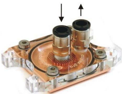
Anders als alle anderen Kühler aus unserem Programm hat der cuplex PRO eine fest vorgegebene Strömungsrichtung. Durch den Aufbau als Düsenkühler muss das Wasser über den mittig angeordneten Anschluss direkt zu den Düsen geleitet werden, die das Wasser mit hoher Geschwindigkeit in den Kühler „einspritzen“. Das Wasser wird anschließend
