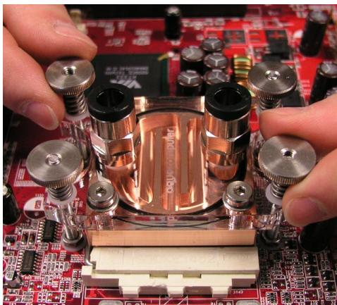
Drehen Sie jetzt auf jede Schraube eine der beigelegten Rändelmuttern ca. 2 Umdrehungen auf, so dass diese gerade greift. Während des nun folgenden Anziehens der Federn müssen sie immer abwechselnd jeweils zwei diagonal gegenüber liegende Rändelmuttern anziehen. Achten Sie während dieses Vorgangs darauf, dass die einzelnen Federgänge nicht aneinander stoßen, da ansonsten unzulässig hohe Kräfte auftreten könnten.
