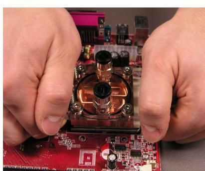
ckels sich über dem Lösemechanismus des Sockels befindet. Damit der Kern nicht beschädigt wird, muss die Kraftentwicklung beim Aufsetzen genau senkrecht zur Oberfläche des Kerns erfolgen. Komprimieren sie die Federn, indem Sie die Daumenballen von oben auf die Edelstahlbleche legen und mit den Fingern
