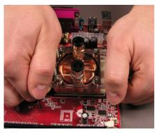
Sockels befindet. Damit der Kern nicht beschädigt wird, muss die Kraftentwicklung beim Aufsetzen genau senkrecht zur Oberfläche des Kerns erfolgen. Komprimieren sie die Federn, indem Sie die Daumenballen von oben auf die Edelstahlbleche legen und mit den Fingern unter den Deckel greifen, und haken Sie die Edelstahlbleche unter die Kunststoffnasen des
