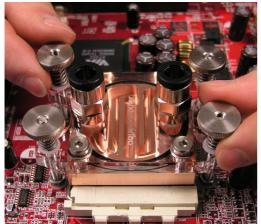
ca. 2 Umdrehungen auf, so dass diese gerade greift. Während des nun folgenden Anziehens der Federn müssen sie immer abwechselnd jeweils zwei diagonal gegenüber liegende Rändelmuttern anziehen. Achten Sie während dieses Vorgangs darauf, dass die einzelnen Federgänge nicht aufeinander stoßen, da ansonsten unzulässig hohe Kräfte auftreten könnten. Die
