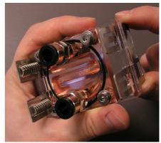
schlossen. Die leicht unterschiedlichen Federwege auf den beiden Seiten bewirken, dass der Druck letztendlich zentral auf den Prozessorkern wirkt ("balanced load"). Setzen Sie nun die Anpressfedern wie auf der Abbil-
