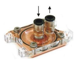
Die Düsen- bzw. Mikrostrukturkühler cuplex XT di und cuplex PRO haben im Gegensatz zu Kanalkühlern eine fest vorgegebene Strömungsrichtung. Im Falle des cuplex PRO muss das Wasser über den mittig angeordneten Anschluss direkt auf die Mikrostruktur geleitet werden, beim cuplex XT di wird das Wasser
