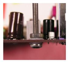
vier Schrauben befestigen. Hierzu müssen Sie zuerst Ihr Motherboard aus dem Gehäuse demontieren. Bei den meisten aktuellen Mainboards muss zunächst die meist schwarze Kunststoffbefestigung für Luftkühler vom Motherboard entfernt werden, um die benötigten Bohrungen im Motherboard freizulegen. Anschließend streifen Sie über eine der beiliegen-
