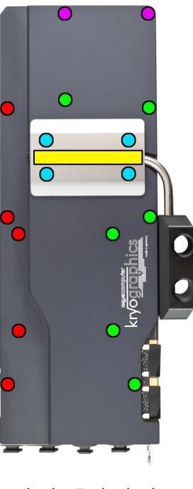
Rot Markierung: fünf Schrauben M2,5 x 8 mm, Senkkopf.
