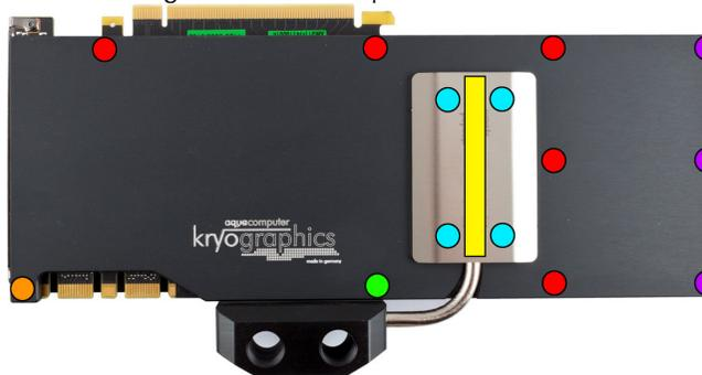
Befestigen Sie Backplate und Grafikkarte an dem Wasserkühler. Verwenden Sie dazu an den im Bild farblich markierten Positionen folgende Schrauben:
