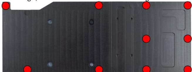
Legen Sie in jede der im Bild rot markierten kreisförmigen Vertiefungen der Backplate jeweils einen der schwarzen Kunststoffringe ein.
