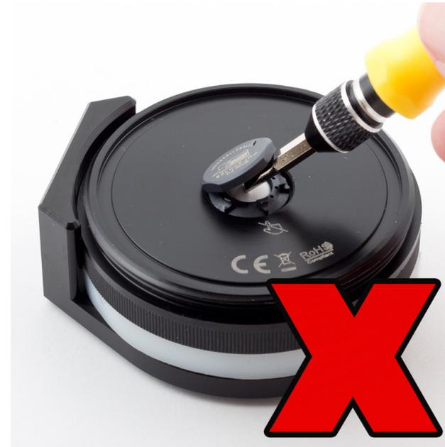
Nutzen Sie beim Entfernen des Schutzdeckels den Schraubendreher nicht von der Mitte heraus als Hebel, da dies die Membran beschädigen würde.
