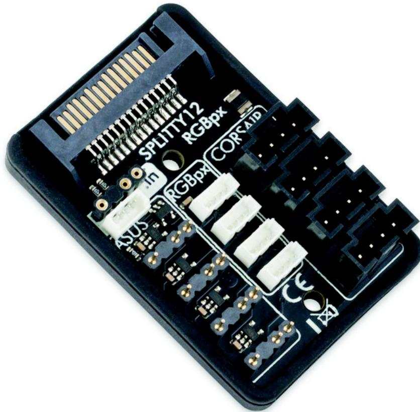
Dieser Splitter kann zum Anschluss von bis zu 12 Beleuchtungskomponenten an einen einzigen RGBpx- oder ARGB-Ausgang verwendet werden. Alle zwölf Ausgänge sind parallel angeschlossen, alle angeschlossenen Komponenten werden identisch angesteuert. Die Spannungsversorgung erfolgt für alle Ausgänge über einen SATA-Stromversorgungsstecker.
