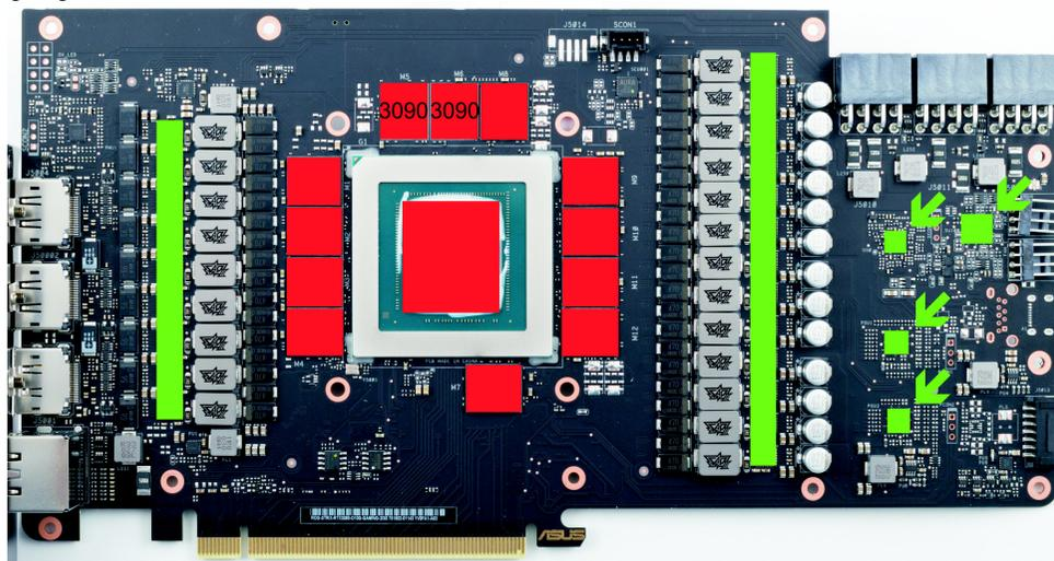
Tragen Sie eine dünne Schicht Wärmeleitpaste auf die GPU und die RAM-Bausteine (zehn RAM-Bausteine bei 3080, zwölf bei 3090) auf. Die Bauteile sind im Bild rot gekennzeichnet. Legen Sie die beiliegenden Wärmeleitpad-Zuschnitte auf die im Bild grün markierten Bauteile auf.
