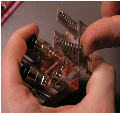
beschrieben mit Wärmeleitpaste vorbereiteten Prozessorkern aufgesetzt werden. Achten Sie darauf, dass der Prozessorkern zentral unter dem Kupferboden des Kühlers liegt und das längere überstehende Stück des Plexiglasdeckels sich über dem Lösemechanismus des
