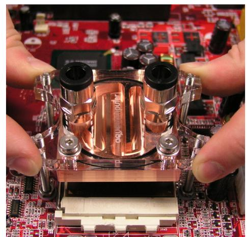
Um den Kühler vor Kratzern zu schützen, stecken Sie jetzt wieder jeweils eine Unterlegscheibe auf die Schrauben. Anschließend stecken Sie auf jeden Stehbolzen eine der beigelegten Federn.
