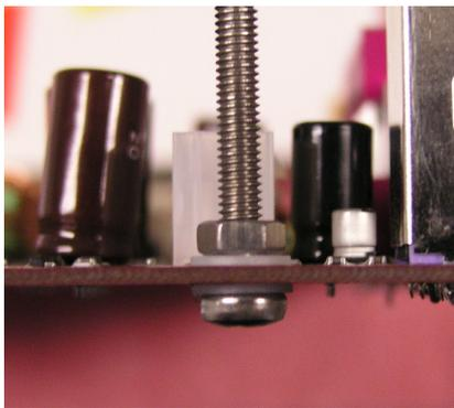
vier Schrauben befestigen. Hierzu müssen Sie zuerst Ihr Motherboard aus dem Gehäuse demontieren. Bei den meisten aktuellen Mainboards muss zunächst die meist schwarze Kunststoffbefestigung für Luftkühler vom Motherboard entfernt werden, um die benötigten Bohrungen im Motherboard freizulegen. Anschließend streifen Sie über eine der beiliegenden
