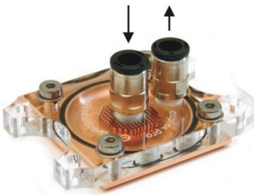
Die Düsen- bzw. Mikrostrukturkühler cuplex kryos, XT di, cuplex hd und cuplex PRO haben im Gegensatz zu Kanalkühlern eine fest vorgegebene Strömungsrichtung. Im Falle des cuplex PRO und cuplex kryos muss das Wasser über den mittig angeordneten Anschluss direkt auf die Mikrostruktur geleitet werden, beim
