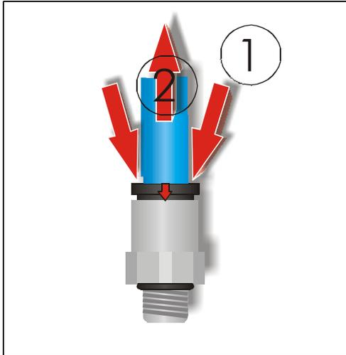
1. Schwarzen oder blauen Kunststoffring am Verbinder nach unten drücken. Dazu kann auch das separat angebotene AC Multi-Tool mit der mittigen Öffnung über den Schlauch geschoben werden.
