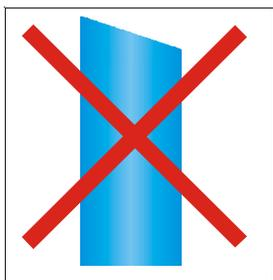
Der Schlauch sollte **ohne Grat** sauber und **gerade** mit einem scharfen Messer oder einem Schlauchschneider (in unserem Shop erhältlich) abgeschnitten werden. Es müssen nach jedem Lösen des Schlauches aus einem Anschluss die ersten beiden Zentimeter Schlauch abgeschnitten werden, um einen sicheren Betrieb zu gewährleisten, da die Halteklammern im Anschluss die Schlachoberfläche beschädigt haben können.
