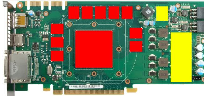
fähig sein! Schneiden Sie aus dem beiliegenden Wärmeleitpad passende Stücke zu und legen Sie sie auf die im Bild gelb markierten Spannungswandler auf.
