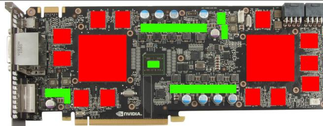
GPUs und die RAM-Bausteine auf. Die Bauteile sind im Bild rot gekennzeichnet. Die verwendete Wärmeleitpaste darf nicht elektrisch leitfähig sein! Schneiden Sie aus dem beiliegenden Wärmeleitpad passende Stücke zu und legen Sie sie auf die im Bild grün markierten Bauteile auf.
