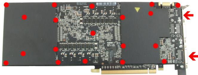
terscheidet sich der Vorgang geringfügig. Ein Teil der Originalschrauben hat einen Torx-Antrieb, für diese Schrauben liegt ein passender Schraubendreher dem aquagraFX für GTX 590 bei. Gehen Sie sehr vorsichtig mit der Grafikkarte und Ihrem Werkzeug vor, um die empfindlichen Komponenten und Leiterbahnen nicht zu beschädigen! Beim Abheben des Luftkühlers von der Grafikkarte muss das Anschlusskabel des Lüfters gelöst werden.
