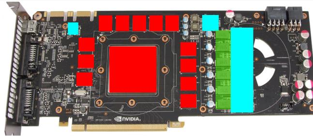
auf die im Bild hellblau markierten Spannungswandler auf. Beachten Sie das Bauteil im Bild oben links! Optional kann im grün markierten Bereich ein 1 mm starkes Wärmeleitpad verwendet werden (im Lieferumfang nicht enthalten).
