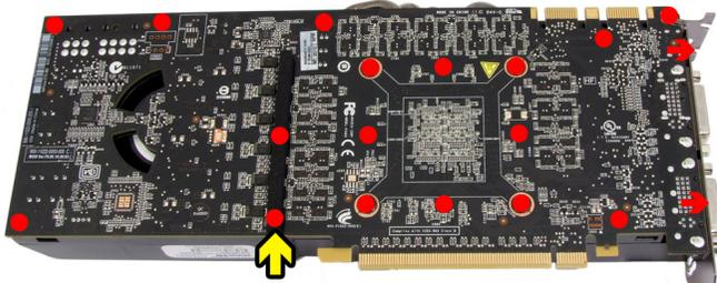
ben. Je nach Bauart der Grafikkarte unterscheidet sich der Vorgang geringfügig. Gehen Sie sehr vorsichtig mit der Grafikkarte und Ihrem Werkzeug vor, um die empfindlichen Komponenten und Leiterbahnen nicht zu beschädigen! Beim Abheben des Luftkühlers von der Grafikkarte muss das Anschlusskabel des Lüfters gelöst werden. Der im Bild mit einem gelben Pfeil markierte Schaumstoffstreifen sollte entfernt werden.
