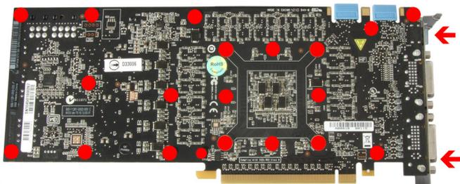
die empfindlichen Komponenten und Leiterbahnen nicht zu beschädigen! Beim Abheben des Luftkühlers von der Grafikkarte muss das Anschlusskabel des Lüfters gelöst werden.
