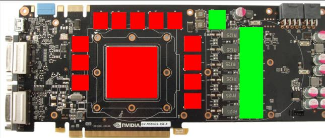
Tragen Sie eine dünne Schicht Wärmeleitpaste auf die GPU und die RAM-Bausteine auf. Die Bauteile sind im Bild rot gekennzeichnet. Die verwendete Wärmeleitpaste darf nicht elektrisch leitfähig sein! Schneiden Sie aus dem beiliegenden Wärmeleitpad passende Stücke zu und legen Sie sie auf die im Bild grün markierten Spannungswandler auf.
