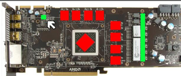
Bringen Sie eine dünne Schicht Wärmeleitpaste auf die GPU und die RAM-Beisteine auf (im Bild rot markiert). Die verwendete Wärmeleitpaste darf nicht elektrisch leitfähig sein! Schneiden Sie aus dem beiliegenden Wärmeleitpad passende Stücke zu und legen Sie sie auf die Spannungswandler (im Bild grün markiert) auf.
