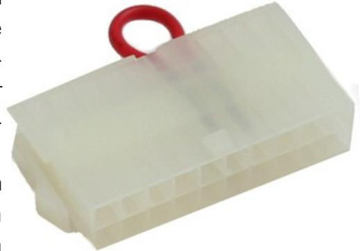
Zum Starten des PC-Netzteils stecken Sie den ATX-Start-Stecker auf den 24- oder 20-poligen ATX-Stecker des Netzteils. Nachdem Sie den Stecker aufgesteckt und das Netzteil eingeschaltet haben, startet das Netzteil und die aquastream ULTIMATE läuft an. Befüllen Sie nun Ihr Wasserkühlsystem.
