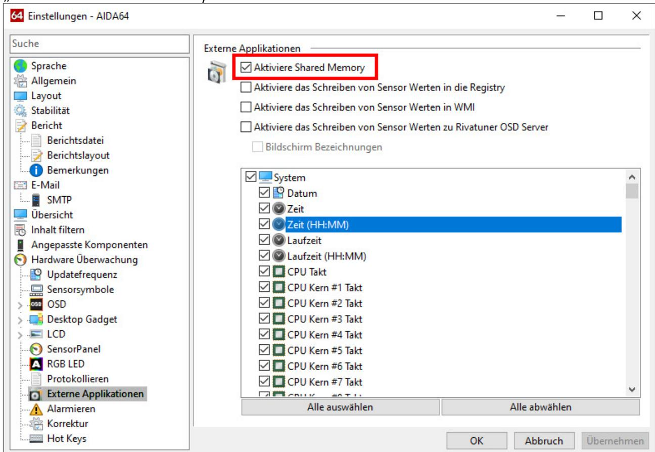
Anschließend kann in der aquasuite nach Mausklick auf die Schaltfläche „Datenquelle“ dem jedem Software-Temperatursensor einer der von der Drittsoftware bereitgestellten Temperatursensorenwerte zugewiesen werden.
