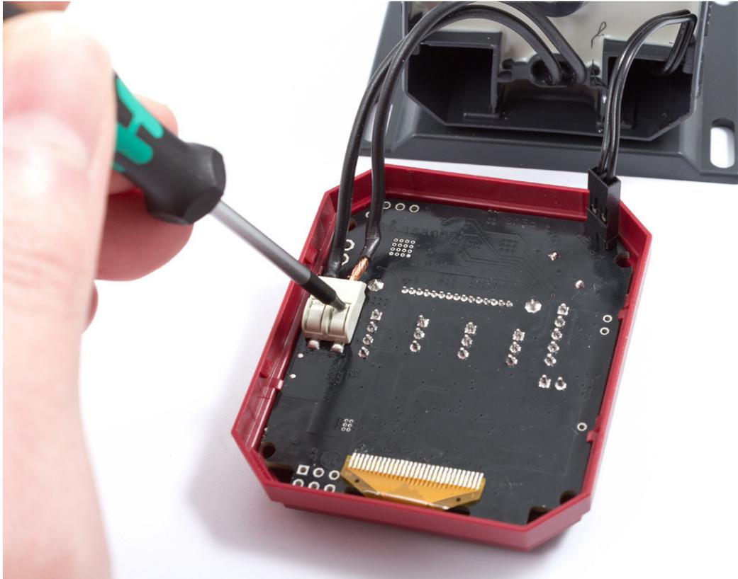
Stecken Sie jeweils ein abisoliertes Kabelende in die beiden Kabelklemmen der Steuerplatine, drücken Sie dabei mit einem kleinen Schraubendreher oder einem Kugelschreiber auf die zugehörige Entriegelungstaste des Klemmverbinders (siehe Foto). Die Polarität der beiden Kabel ist beliebig. Verbinden Sie den Temperatursensor-Steckverbinder mit der passenden Stiftleiste der Steuerplatine. Auch hier ist die Polarität beliebig.
