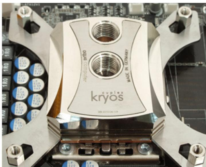
Der cuplex kryos ist nicht symmetrisch aufgebaut, ebenso sind die meisten aktuellen CPUs (unter dem Heatspreader) nicht symmetrisch. Um das volle Kühlpotential des cuplex kryos zu nutzen, sollte er wie auf der Abbildung zu sehen ausgerichtet werden.
