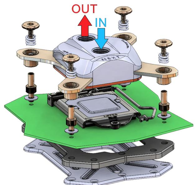
den Rändelschrauben (nur ca. 2 Umdrehungen). Ziehen Sie nun immer abwechselnd jeweils zwei diagonal gegenüberliegende Rändelschrauben etwas fester, bis alle vier Schrauben bis zum Anschlag eingeschraubt sind.
