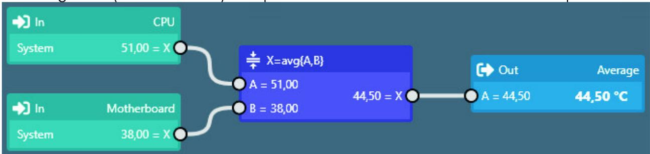
Die virtuellen Softwaresensoren werden einmal pro Sekunde aktualisiert und mit den in diesem Moment gültigen Werten neu berechnet. Entsprechend können bei sich schnell verändernden Eingangswerten Extremwerte für die Berechnung verwendet werden oder bei der Berechnung unberücksichtigt bleiben. Eine Glättung oder Mittelwertbildung findet nicht statt.
