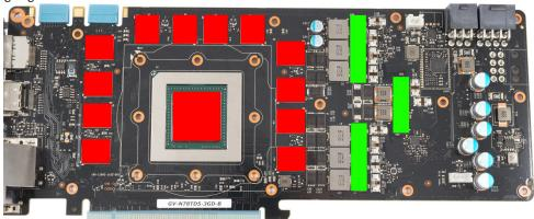
Tragen Sie eine dünne Schicht Wärmeleitpaste auf die GPU und die RAM-Bausteine auf. Die Bauteile sind im Bild rot gekennzeichnet. Die verwendete Wärmeleitpaste darf nicht elektrisch leitfähig sein! Schneiden Sie aus dem beiliegenden Wärmeleitpad passende Stücke zu und legen Sie sie auf die im Bild grün markierten Spannungswandler auf.
