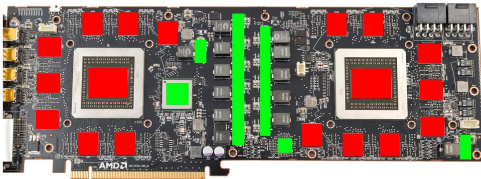
Tragen Sie eine dünne Schicht Wärmeleitpaste auf die GPUs und die RAM-Bausteine auf. Die Bauteile sind im Bild rot gekennzeichnet. Die verwendete Wärmeleitpaste darf nicht elektrisch leitfähig sein! Schneiden Sie aus dem beiliegenden Wärmeleitpad passende Stücke zu und legen Sie sie auf die im Bild grün markierten Bauteile (Spannungswandler und PCIe-Switch) auf.
