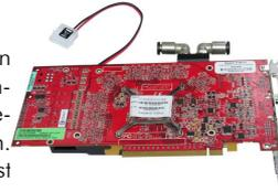
angezogen werden, da die Spannungsregler äußerst empfindlich sind!
