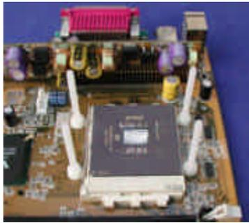
auf die vier Stehbolzen gesteckt werden. Führen Sie ihn ohne zu verkanten langsam herab, bis er auf dem vorbereiteten Prozessorkern aufliegt.
