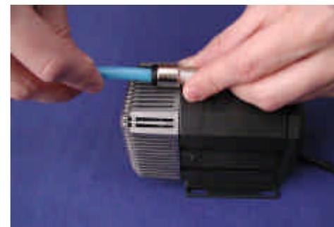
Der Pumpe liegt eine eigene Gebrauchsanweisung der Firma Eheim bei. Bitte lesen Sie zunächst diese durch und beachten Sie die dort abgedruckten Hinweise. Die Pumpe wird von uns mit Anschlüssen für das plug&cool System ausgerüstet. Somit brauchen wir auf die Installation der Schläuche hier nicht noch einmal eingehen. Sie zunächst nur den Schlauch am Druckstutzen (Oberseite der Pumpe, wie in der Abbildung), da Sie die Pumpe zum Befüllen des Systems
