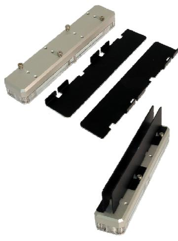
Wenn nur ein Speichermodul pro ramplex montiert werden soll, klebt man die Wärmeleitpads (nicht im Lieferumfang enthalten) direkt auf beide Seiten des Speichermoduls. An den äußeren beiden Gewindereihen wird jetzt ein Kühlblech montiert. Die Kühlflächen zeigen dabei zueinander. Das RAM-Modul wird anschließend zwischen die beiden Bleche gesteckt.
