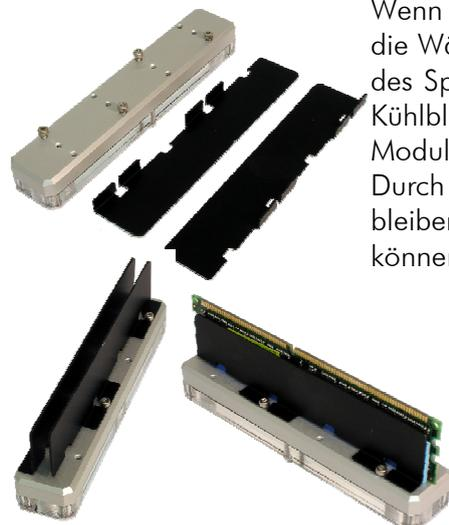
Wenn nur ein Speichermodul pro ramplex montiert werden soll, klebt man die Wärmeleitpads (nicht im Lieferumfang enthalten) direkt auf beide Seiten des Speichermoduls. An den äußeren beiden Gewindereihen wird jetzt ein Kühlblech montiert. Die Kühlflächen zeigen dabei zueinander. Das RAM-Modul wird anschließend zwischen die beiden Bleche gesteckt.
