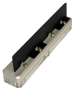
Für die Montage auf zwei oder drei Speichermodulen werden insgesamt vier Kühlbleche (bei zwei RAM-Modulen) oder sechs Kühlbleche (bei drei RAM-Modulen) verwendet. Bitte beachten Sie, dass sich nur vier Kühlbleche im Lieferumfang des Kühlers befinden. Für die Montage eines dritten RAM-Moduls müssen Sie einen Satz zusätzliche Kühlbleche erwerben.
